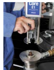
3. Faites glisser le moteur électrique pour le retirer
